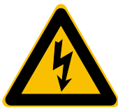
WS801 Gevaarlijk elektrische spanning
